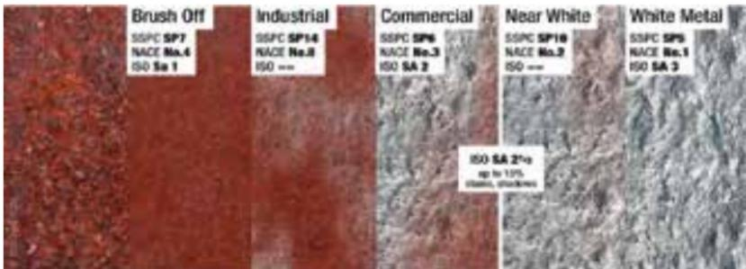
Normreinheitsgrad von Stahlbewehrung
