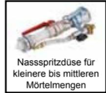
Vor dem Spritzen durchströmt der Spritzmörtel mit hoher Geschwindigkeit die Spritzdüse. Dort wird der Spritzstrahl geformt und die notwendige Druckluft beim Dichtstromverfahren zudosiert. Die nun fertig zubereitete Spritzmörtelmischung schießt unter hohem Druck auf den Untergrund und verdichtet sich dabei so stark, dass augenblicklich eine fertig verdichtete Mörtelstruktur entsteht, welche je nach gewähltem ERGELIT® Mörtel in allen Richtungen, auch senkrecht über Kopf, aufgetragen werden kann.
