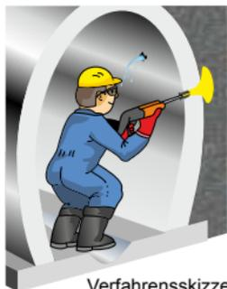
Das ausgehärtete Harz dichtet die Schadstellen dauerhaft ab. Es eignet sich sehr gut im Bereich von Kanalschächten und begehbaren Abwasserkanälen.
