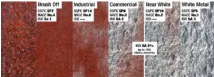
Normreinheitsgrad von Stahlbewehrung
