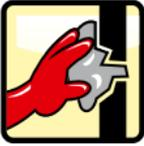
Mit ERGELIT-10SD, so genannter „Knete“, werden auch punktuelle intensive Wassereinträge schnell und dauerhaft abgedichtet. Hierzu wird die Wassereinbruchsstelle auf  $\varnothing$  25 mm 20 – 30 mm tief aufgebohrt und der mit Wasser angemischte schnellverdichtete ERGELIT-Mörtel wie eine Knete in die Stelle gedrückt
