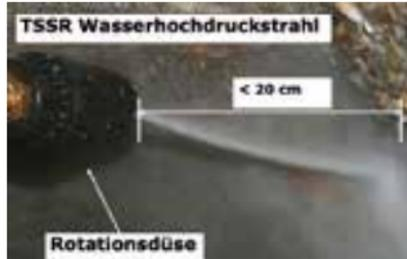
Das gestrahlte Bauteil ist durch Wasserstrahlen mit Druck unter 10 bar (Hydrantendruck) von losem Sand oder Schmutzbestandteilen immer abzuwaschen
