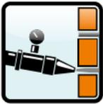
Oft sind beim Mauerwerk nur die Lager- und Stoßfugen korrodiert. In diesen Fällen braucht die Fuge nur 2-3cm ausgeräumt werden. Sie wird vor der Beschichtung mit einem WW-Fugenmörtel verfüllt. ERGELIT-KBi oder ERGELIT-KS1 eignen sich dafür. Der Mörtel
