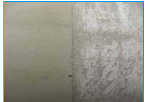
Die linke Seite zeigt das ERGELIT-NUM bzw. die rechte Seite die FZM-ummantelte Stahlrohrleitung
