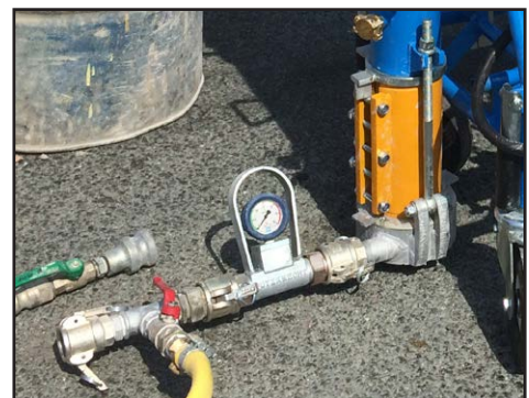
Sortie de pompe avec post-malaxeur
